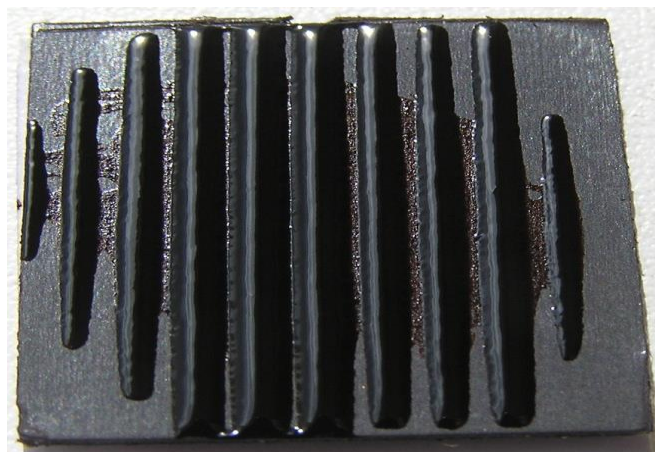
Рис. 3. Намагниченность магнитного эластомерного материала
