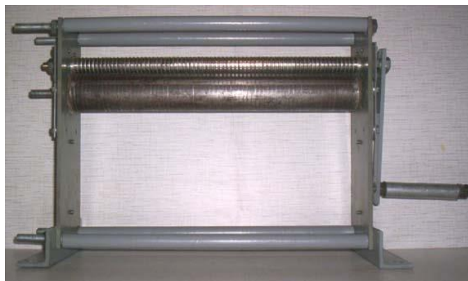
Рис. 2. Валки для непрерывного многополюсного одностороннего намагничивания листовых магнитоэластомерных материалов
