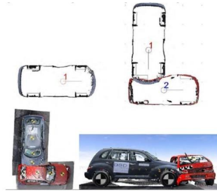
Рис. 3. Моделирование сканированных пространственных поверхностей автотранспортных средств
