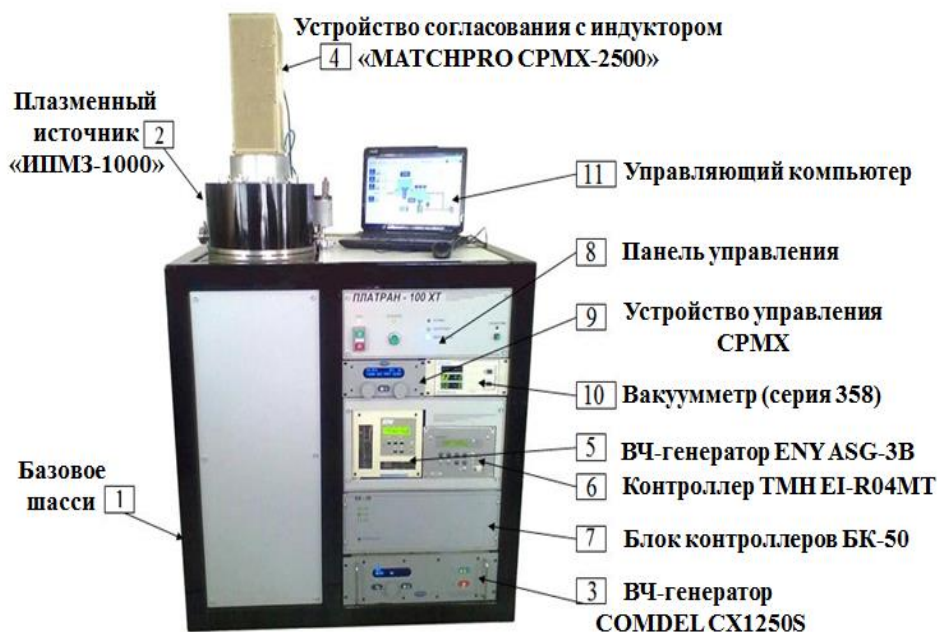
Рис. 1. Общий вид и конструкция установки Платран100ХТ.
